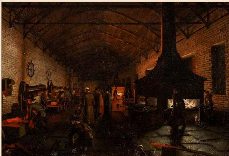
Кричный цех уральского железодельного завода. П. Ф. Худояров, 1830-е годы. Традиционное кричное производство продолжало использоваться на уральских заводах и после появления пудлинговых печей.
